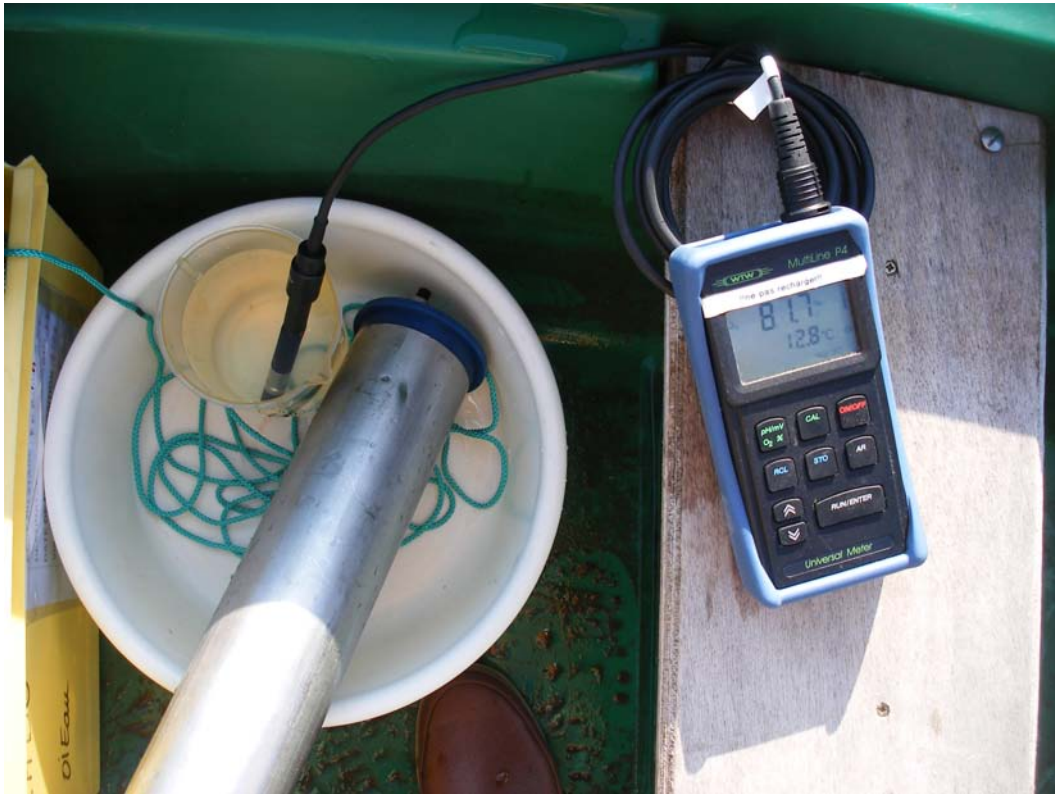
Mesure de la quantité d'oxygène en pourcentage
