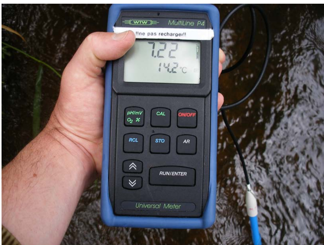
Mesure du pH sur un cours d'eau
