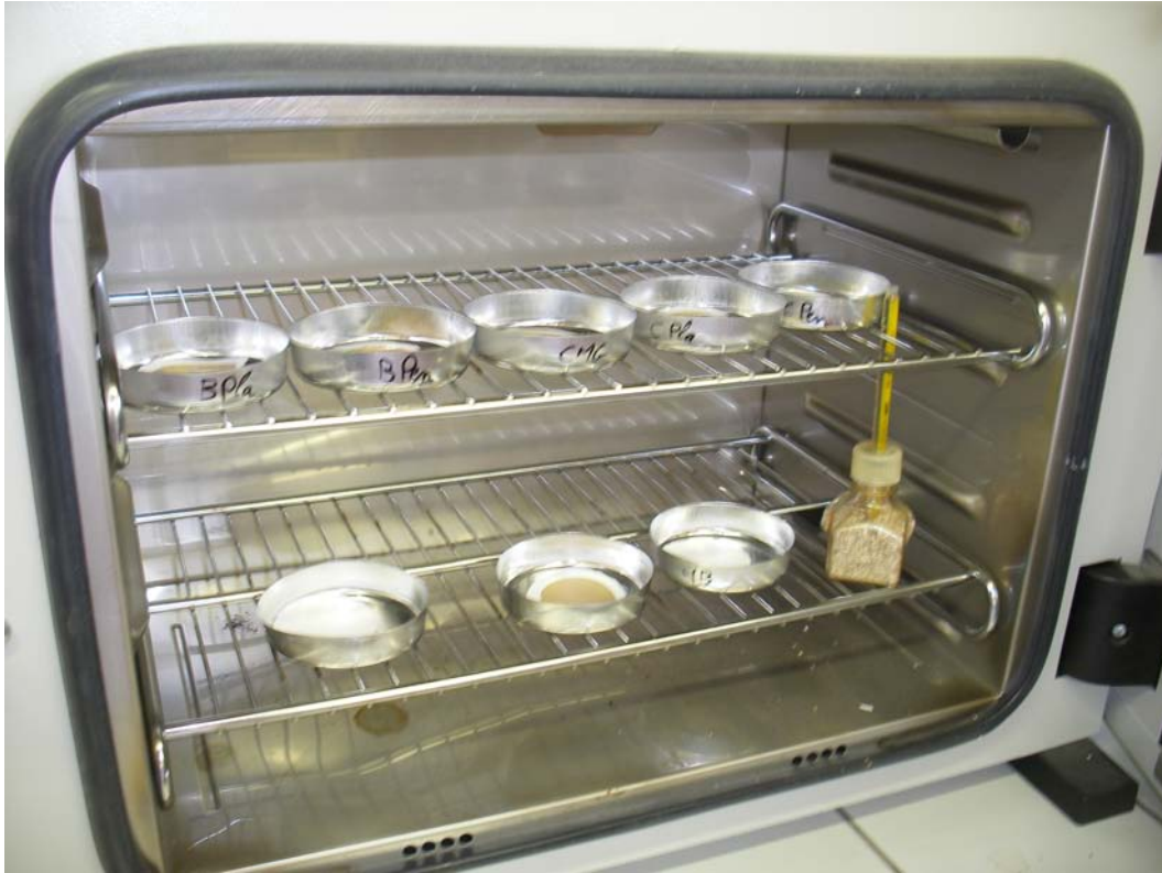
Filtres placés dans l'étuve
