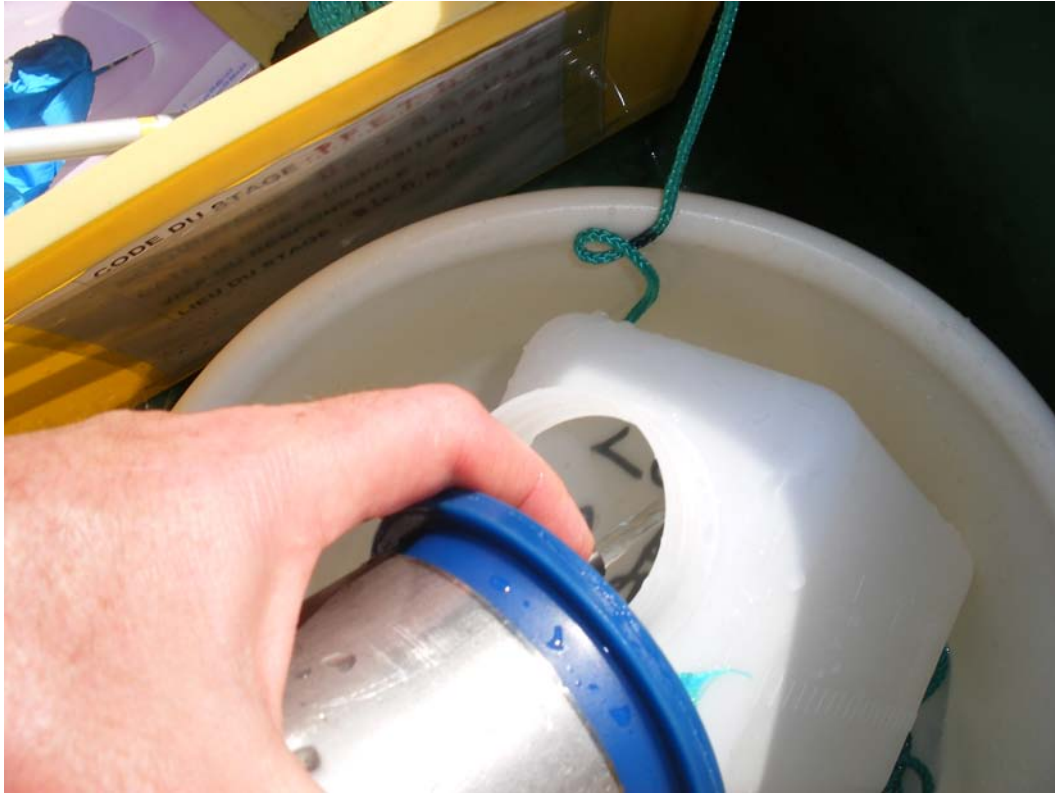
Prélèvement d'eau en profondeur
